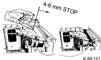
**B) vérifier la surface de la chaîne.** la faire tourner une fois en continu. La chaîne doit former une surface continue;
