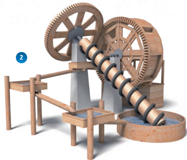
2 Archimedisches Wasserrad Archimedes water wheel
